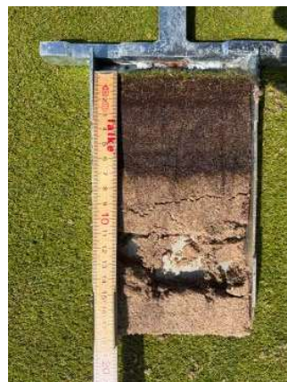
Billede 3. Billede af en greenprofil fra green 13. Tydelig lagdeling ved 7-8 cm, rod dybde til 11-12 cm samt filttag i 2-3 cm (svært at se på billedet).
